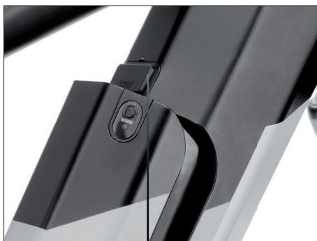
Pro vyjmutí baterie zmáčkněte zámek/lock umístěný na rámu elektrokola nad baterií.
