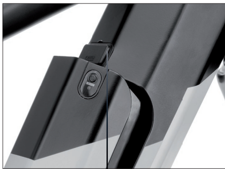
Pre vybratie batérie stlačte zámok/lock umiestnený na ráme elektrobicykla nad batériou
