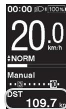
2. Podržte tlačidlo Asistenčný režim A, kým nezačne hodnota pod položkou [DST] blikat.
